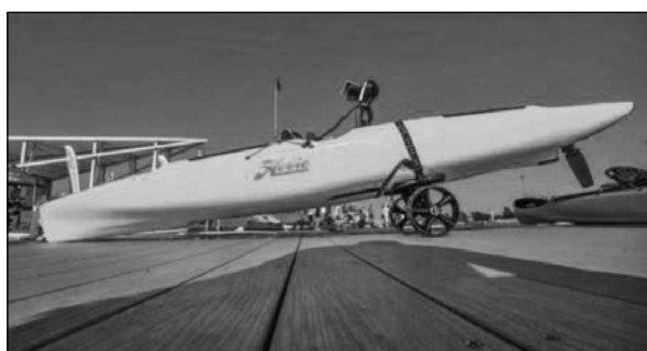
Obrázek 13 Speciální vozík pro kajaky a kanoe upevněný na kajaku ( www.railblaza.com )
