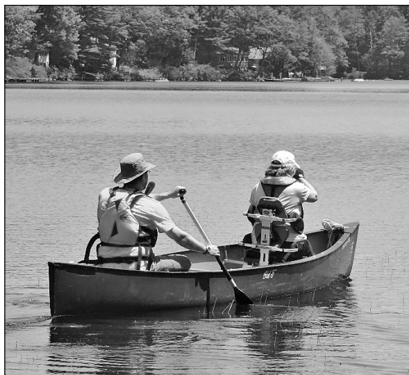
Obrázek 22 Univerzální pádlovací sedačka pro kanoe umístěná v kanoi ( www.americancanoe.org )
