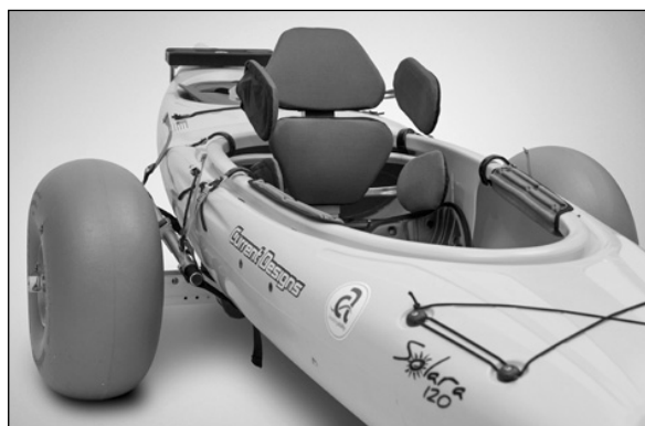
Obrázek 15 Speciální kajakový vozík připevněný na kajaku ( www.creatingability.com )
