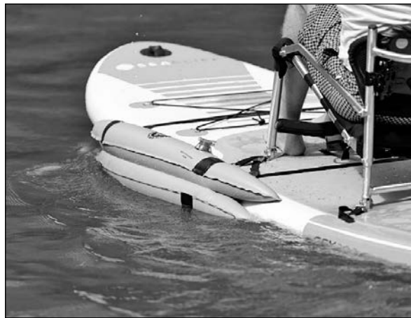
Obrázek 37 Speciálně upravený paddleboard se sedačkou a postranními plováky ( www.pushmobility.com.au )
