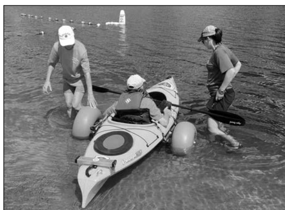
Obrázek 16 Speciální kajakový vozík připevněný na kajaku ve vodě ( www.mass.gov )
