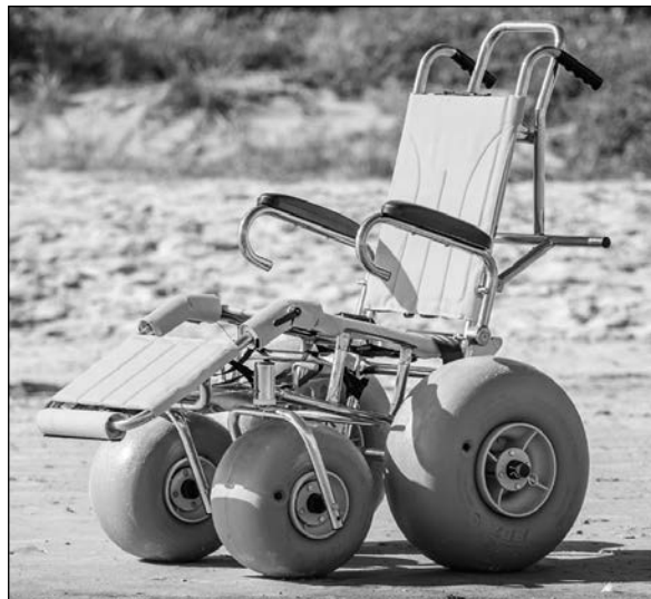
Obrázek 49 Speciálně upravený invalidní vozík pro děti do terénu na pláži ( https://wheeleez.com )
