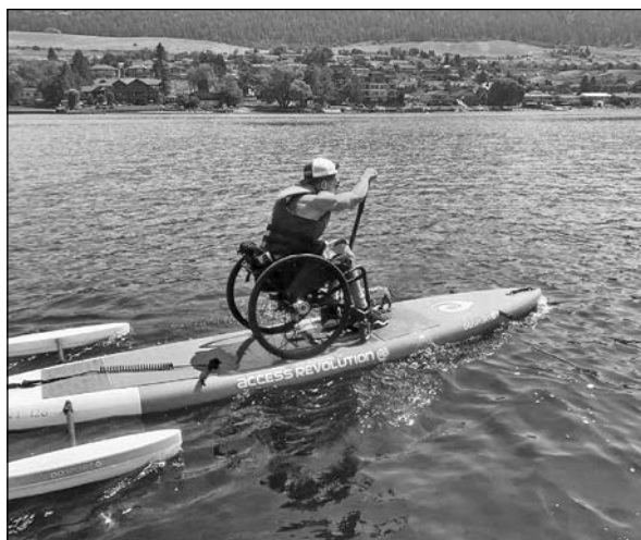
Obrázek 40 Speciální paddleboard s plováky a invalidním vozíkem na vodě ( dosport.ca )
